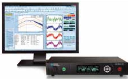
网络连接不会影响控制的可靠性。随着无线网络路由器的应用，PC 可以通过 Wi-Fi 轻松地连接到远程的 Spider。
