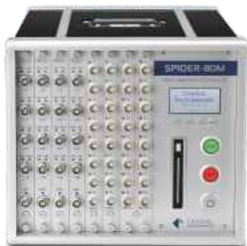
Spider-80M专用于MIMO控制和MIMO结构测试应用
